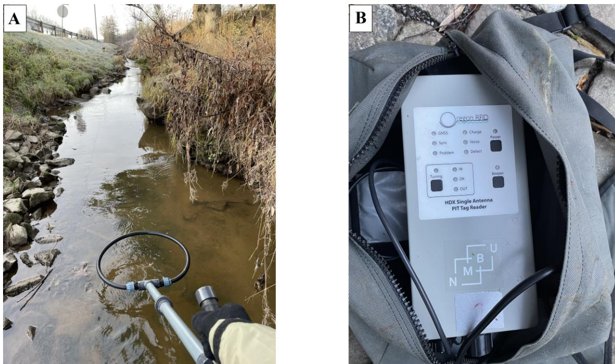
Figur 3. A: Manuell PIT-peiling ble gjennomført med en Oregon RFID HDX Single Antenna PIT Tag Reader. B: Mottakeren til antennen var plassert i en ryggsekk med et oppladbart batteri. Foto: Eivind Wolden.
