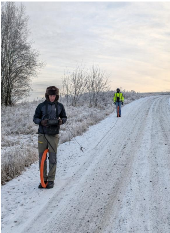
Figur 13: Bildet viser bruk av EM34-3 i horisontal dipol modus med 10m avstand mellom antennene.
