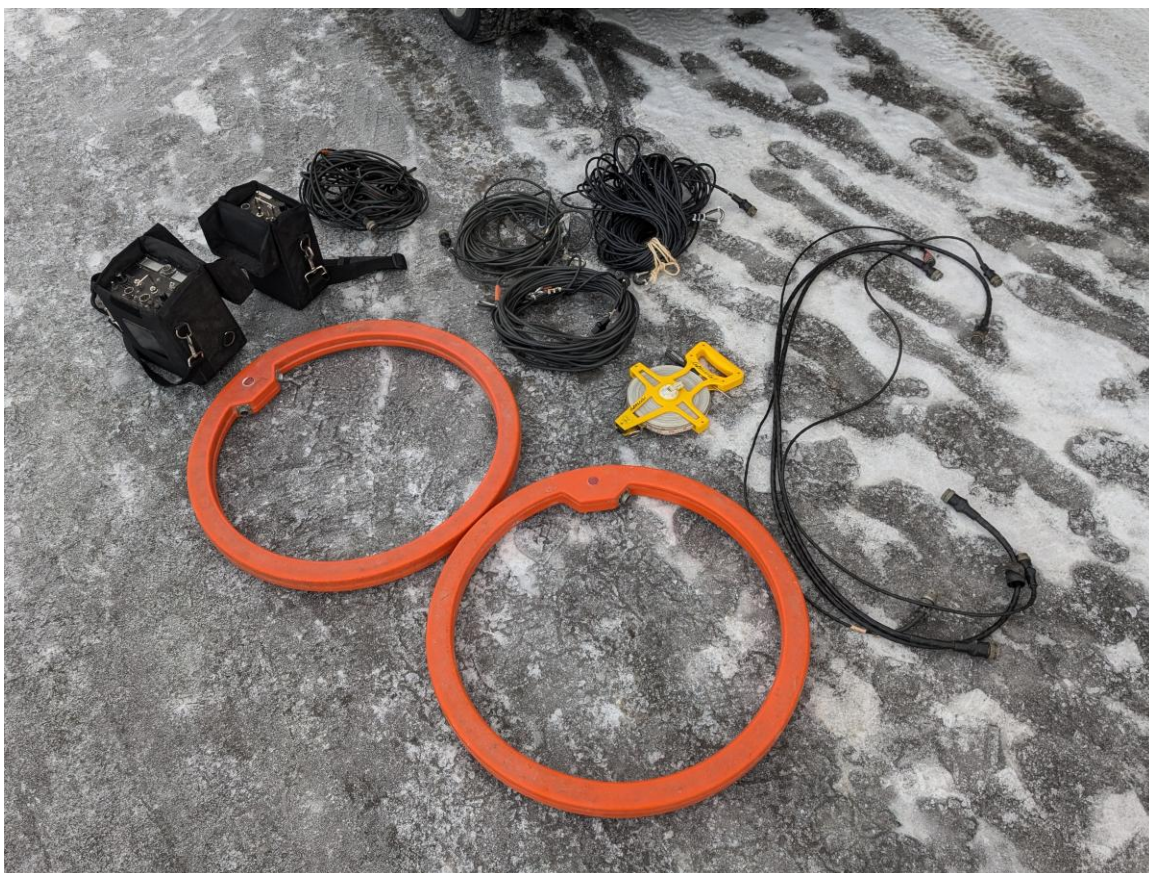
Figur 12 Bildet viser oversikt over utstyret: RX og TX antenne og monitor, samt kabler for kobling mellom antenne og tilhørende monitor og kabler for bruk med antenneavstand 10, 20 og 40m og målebånd for kontroll av korrekt innstilling og antenneavstand ved første måling.
