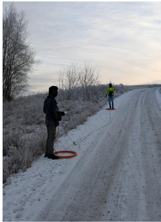
Figur 14: Bildet viser bruk av EM34-3 i vertikal dipol modus med 10m avstand mellom antennene.
