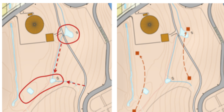
Figur 15: Den konstruerte våtmarken med røde piler som illustrerer hvor bekkene som tilfører vann renner fra, og den røde sirkelen viser forsedimenteringsdammen. De små svarte firkantene inni de røde markeringene viser mottakskulpene som tar imot vann fra bunnledningene. Bildet til høyre viser deler av disgolfbanen som er i den konstruerte våtmarken, og hvor spillere beveger seg. Bakgrunnskart hentet fra Kartverket, norgeskart.no. Merknader på kartet laget av Nummelin, M., 2025.
