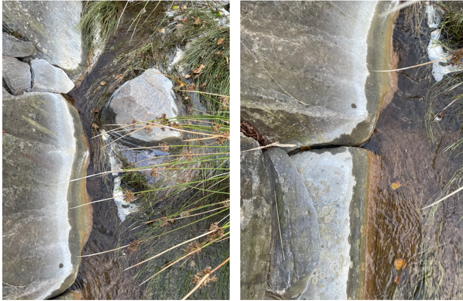
Bilde 6 - Metallutfelling i vann og hvitt/grått og rød/brunaktig belegg på stein, fra lokasjon A. Bilde er tatt i forbindelse med feltarbeid i august (Foto: Frida H. Håtteit, 2024)
