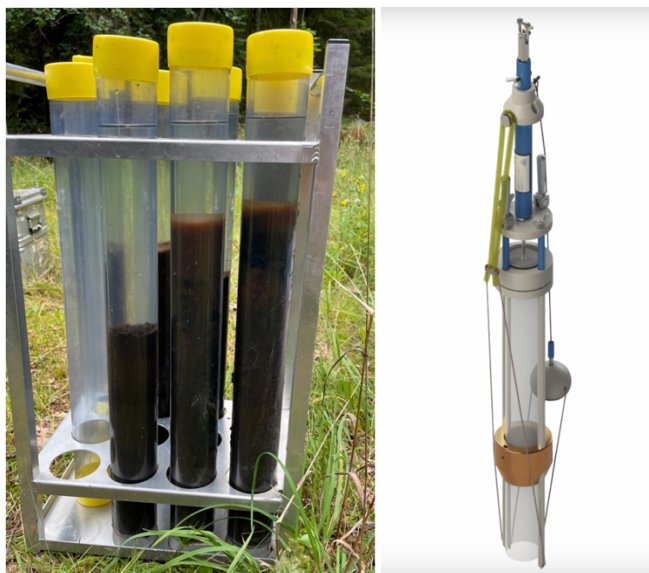
Bilde 1 - Sedimentkjerner (t.v.), USC gravitasjonskjerneprøvetaker (t.h.) (foto av sedimentkjerner er tatt av Bjørn Loland, 28.aug 2024, foto av prøvetaker er hentet fra (UWITEC, u.å.-a))
