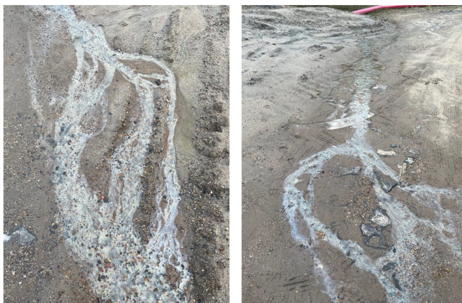
Bilde 5 - Metallutfelling på KIL5/6, som ligger overfor lokasjon A. Bildet er tatt i forbindelse med i august. (Foto: Frida H. Håtteit, 2024)
