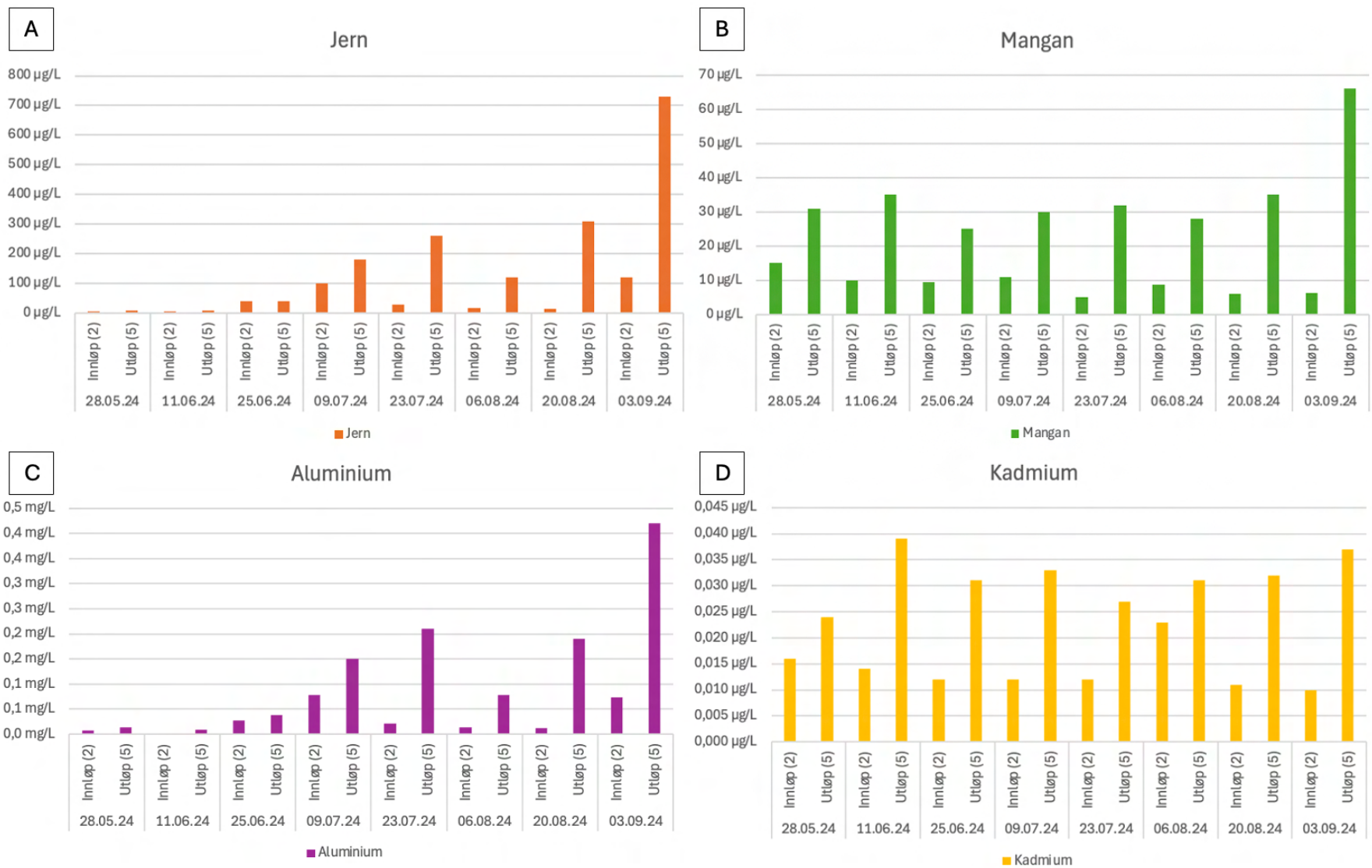
Figur 28. Målt konsentrasjon av ulike metaller ved inn- og utløpet av fordrøyningsdammen, annenhver uke fra 28. mai-3. september 2024. A: Jern, B: Mangan, C: Aluminium og D: Kadmium. De to første prøvetakningsdatoene (28.05.24 og 11.06.24) ble vannprøvene filtrert.
