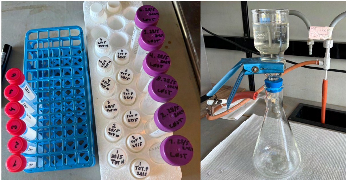
Figur 10. Til venstre: Oppsett av prøverør med markeringer. Til høyre: Oppsett av filtrering av vannprøver.
