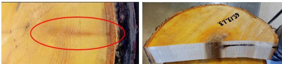
Figur 9. Årringenes eksentriske form gjorde det synlig for hvordan kvisten var orientert fra marg. For flere prøver var det bedre å skjære frihånd enn ren kløyvsaging.
