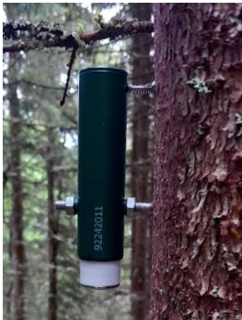
Figur 4: Punktdendrometer (Tomst, Brno, Tjekkia) som måler radiell vekst.
