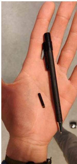
Figur 4: PIT-merke (Passive Integrated Transponder) av type half duplex på 23 mm ved siden av en svart pen.
