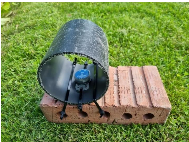
Figur 3: Bilde av oppsettet for måling av vanntemperatur. Foto: Olsen, G.H, 2022.
