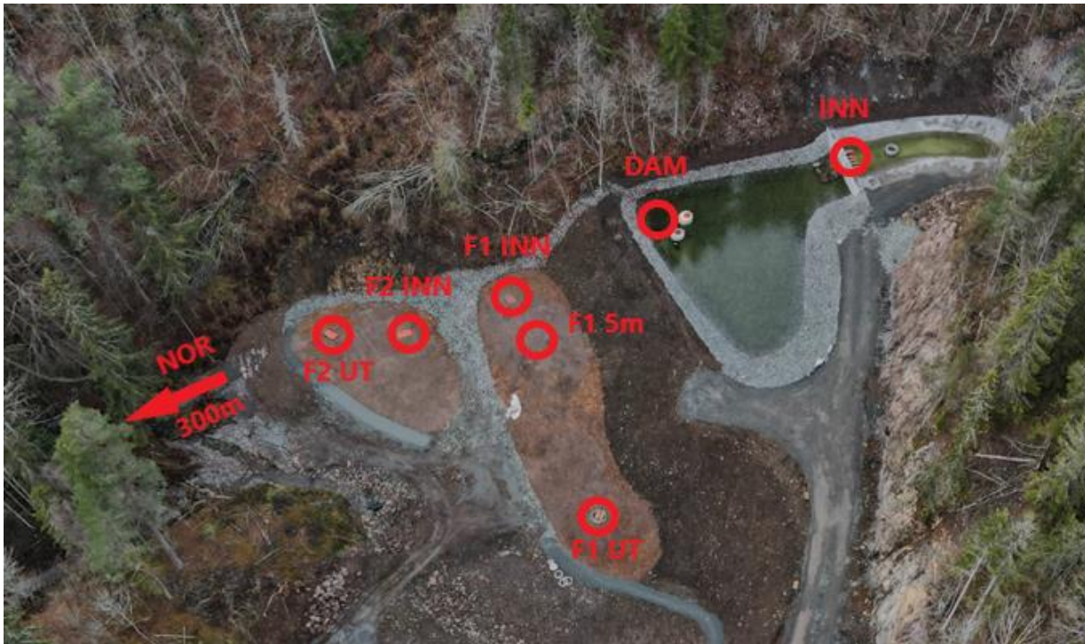
Figur 10. Loggestasjoner for vannkvalitet i renseanlegget (dronebilde, SVV. Illustrasjoner, Magnus Evang).
