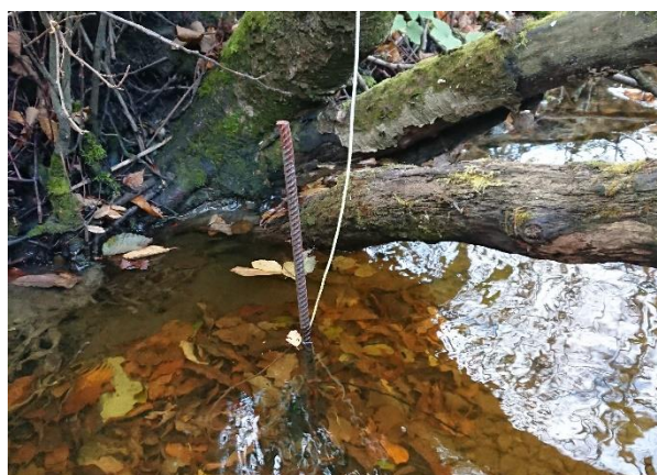
Bilde 12: Vannlogger festet til armeringsjern med strips og sikret med hyssing. Her fra Brokskitbekken.
