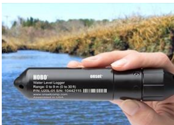
Bilde 11: HOBO U20L-vannloggerne som ble benyttet.
