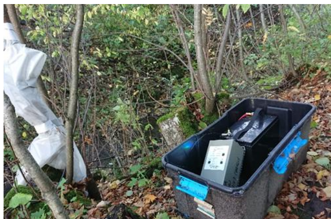
Bilde 8: PIT-leser i oppbevaringsboks og tilknyttet tuner (innpakket i plast til venstre). Her fra Korsådsbekken.
