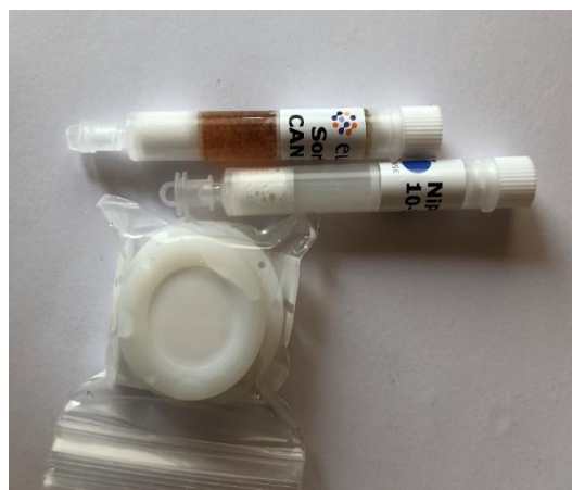
Figur 13. Til venstre: flasker med SorbiCell fra prøvepunkt nedstrøms deponiet ved opptak. Til høyre: DGT og SorbiCell etter opptak og før forsendelse til lab. (Foto: AH Rosenvinge)
