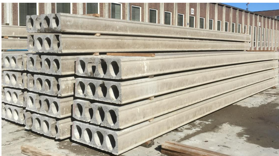
Figur 5: Hulldekkeelementer i betong (Contiga AS, 2020)
