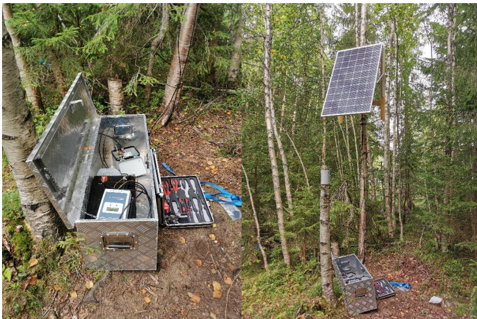
Figur 7 (t.v.): Aluminiumsboks med batteri, PIT-tag-registreringsboks, laderregulator, solcellepanel-reguleringsboks og avfukter.
