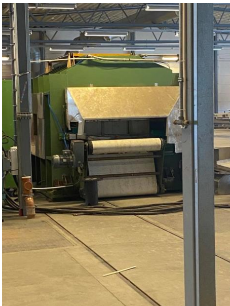
Figur 7 Limpressen hos Ottadalen Massivtre (Foto: Jo Håvard G. Gjerdrum)
