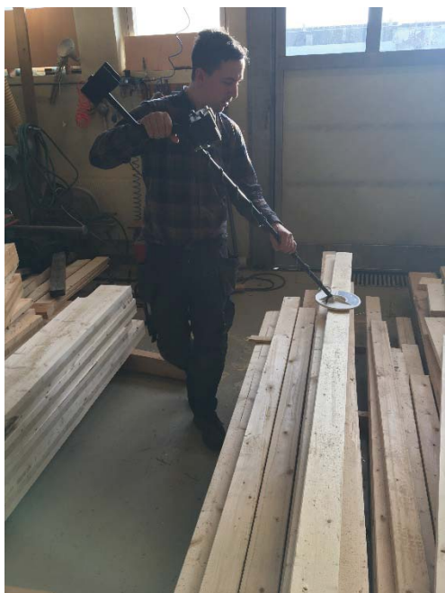
Figur 3-8: Metallsøking i returvirke før høvling.
