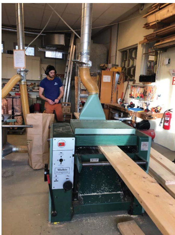
Figur 3-9: Tykkelseshøvling av returvirke.
