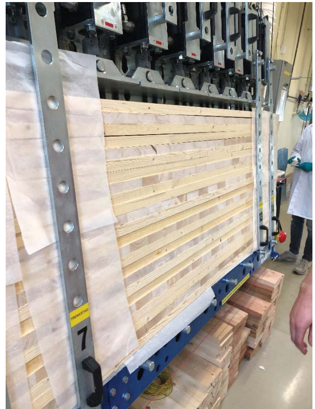
Figur 3-16: 8 testelementer lagt i pressen.
