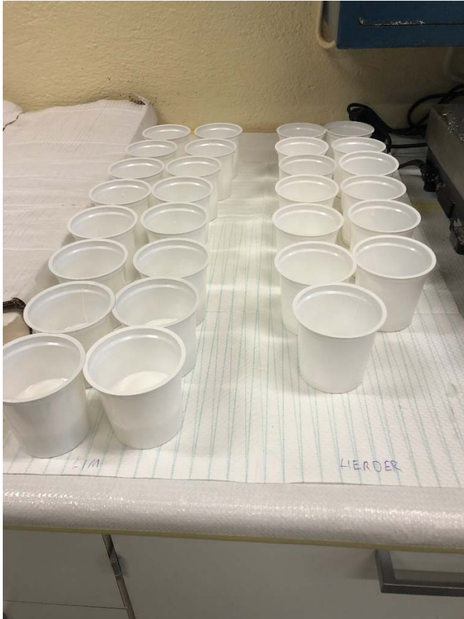
Figur 3-14: Ferdig oppmålt mengde lim og herder.
