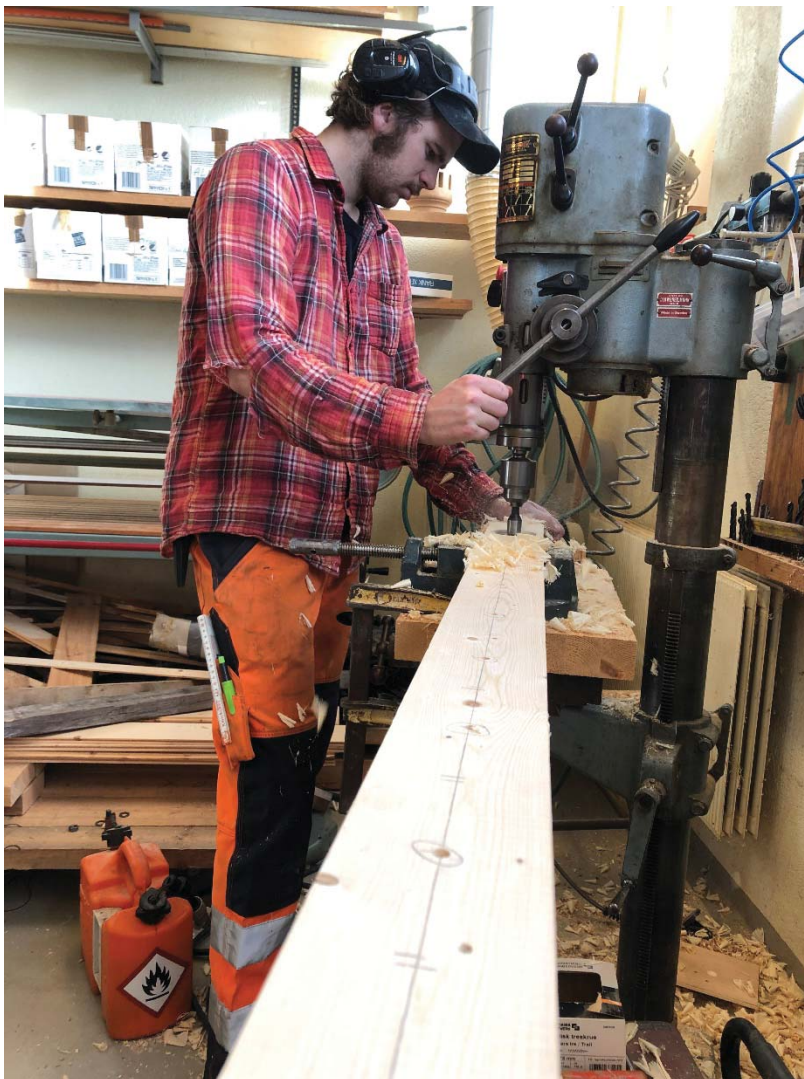
Figur 3-10: Boring av 76 mm hull sentrert i 98 mm bred lamell.
