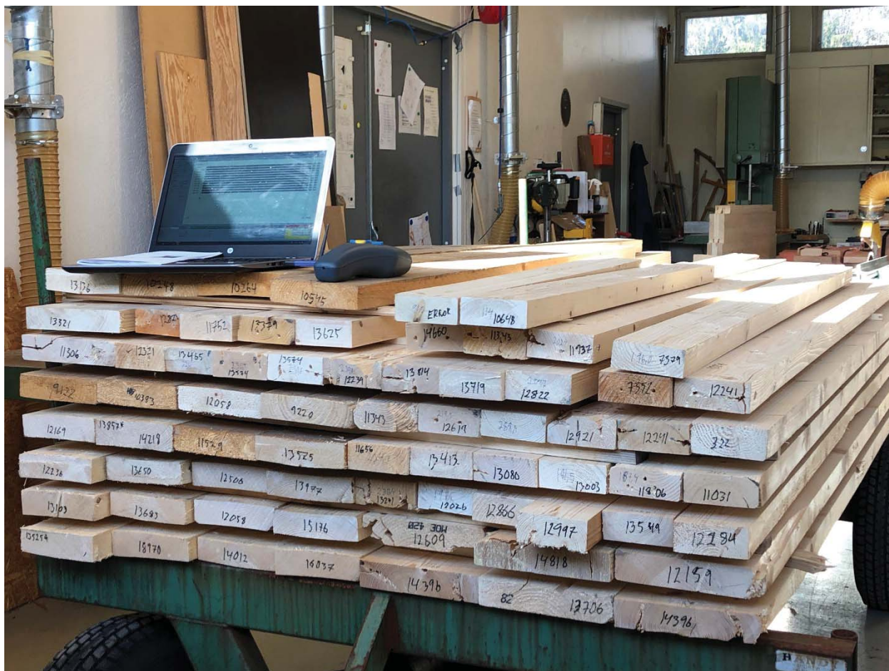
Figur 3-7: Stabel med styrkesortert returvirke, E-modul målt med Brookhois markert i endeveden.
