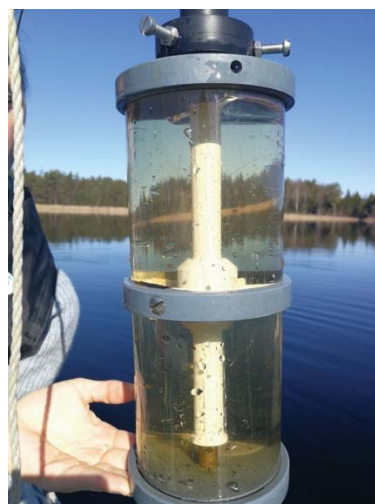
Bilde 3a (venstre). Filtreringsutstyret som ble brukt i felt. Bilde 3b (høyre). Vannprøve tatt i felt
