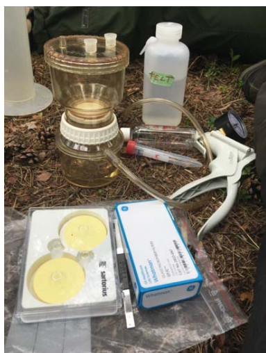
Bilde 3a (venstre). Filtreringsutstyret som ble brukt i felt. Bilde 3b (høyre). Vannprøve tatt i felt
