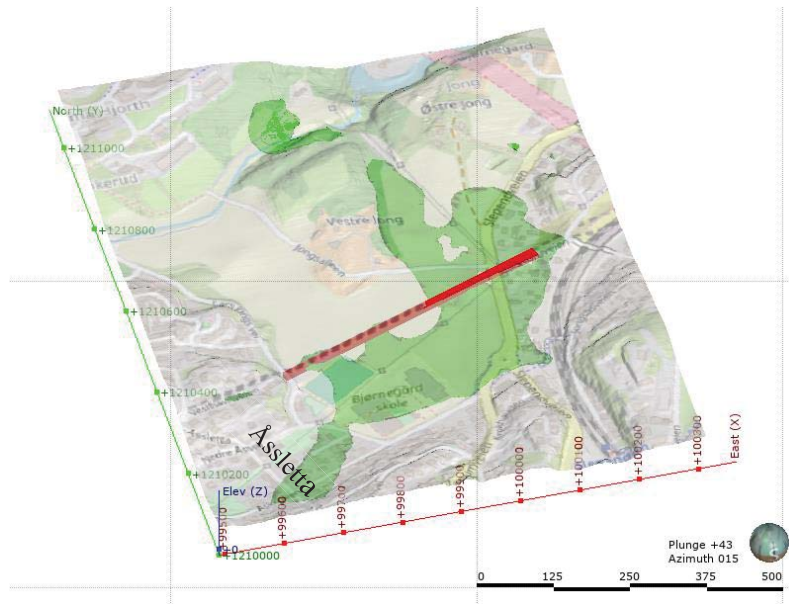
Figur 17 Viser utbredelsen til morenelaget i forhold til terrengoverflaten og byggegropp (rødt felt). Illustrasjon generert i Leapfrog work.
