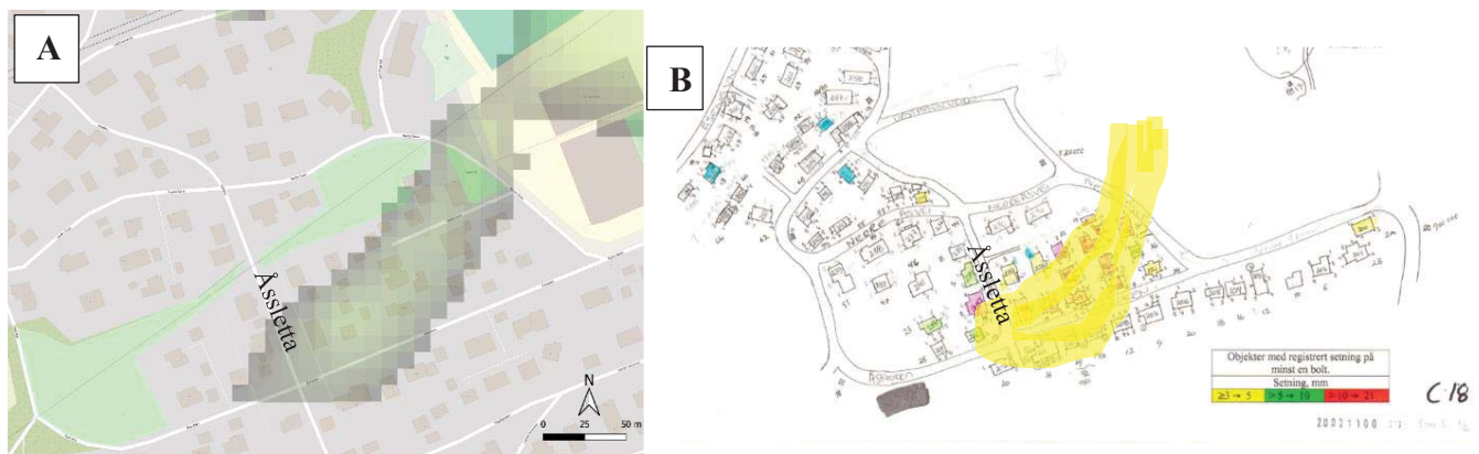
Figur 31 A) viser hvor morenelaget ligger ved Åssletta, B) viser hvilke bygg det er observert setninger i forskjellige størrelser (Modifisert etter Klevland (2005)).
