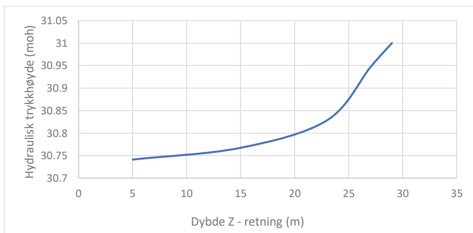
Figur 27 Grafen viser hydraulisk trykkverdier i forhold til dybden i profilet (Z retning) ved en distanse på 400 meter fra byggegropen.
