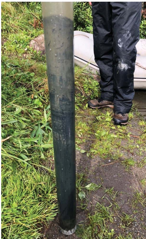
Figur 11. Sedimentsøylen som ble hentet opp fra Østensjøvannet ved feltarbeidet 16.august 2019 med Uwitec sedimentprøvetaker. I den øvre delen av søylen var det et lag av lysere grå-brun farge. I midtdelen var det et felt av sedimenter med mørkere farge som gikk over til et lag med lysere fargetoner mot bunnlaget. Foto: K.B. Olsen, 2019.
