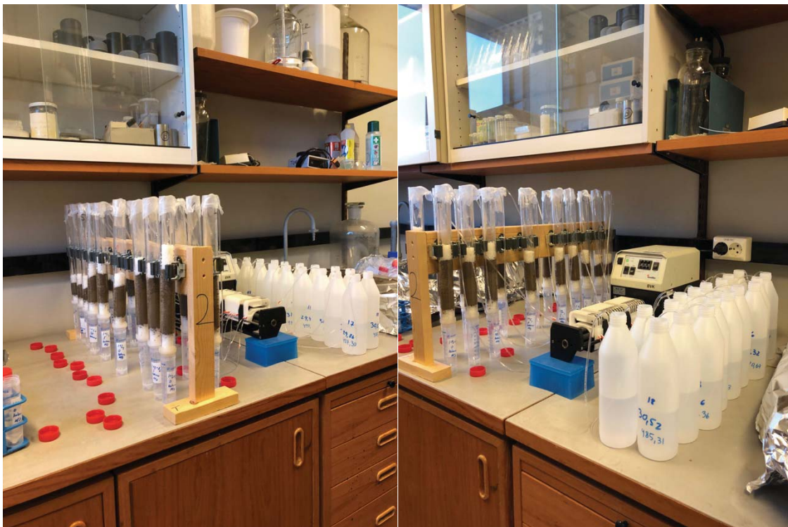
Figur 4. Bildene viser oppsettet av kolonneforsøket vist fra begge sider. Bildene viser seks rør av hver sjiktoppbygging (1A+XO+XOG, 1A+XO og 1A) samt tilhørende slanger og vannflasker.
