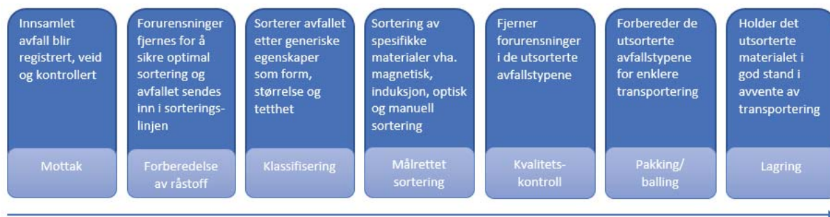
Figur 2: Sorteringsprosessene ved et typisk ettersorteringsanlegg, oversatt fra engelsk (ISWA, 2017).
