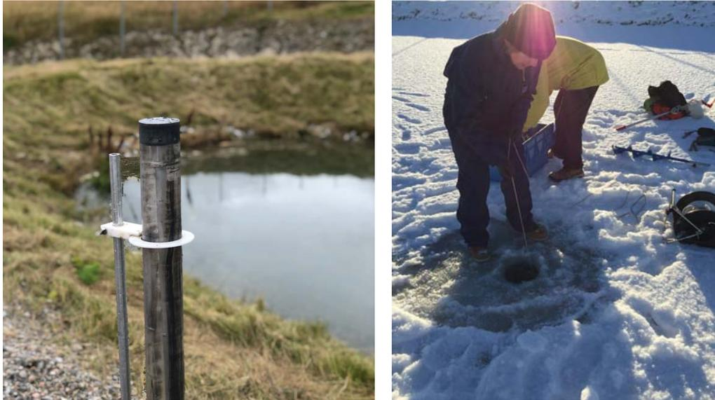
Figur 9: Sedimentprøvetaking, 9. januar 2019 og 22. august 2019. I januar ble det benyttet isbor i motsetning til sommerstid da det ble benyttet gummibåt.
