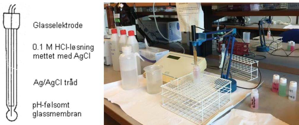
Figur 11: pH-meter, bilde viser pH måling av vannprøver. Illustrasjon av glasselektrode er hentet fra (Miljøolare, u.å).
