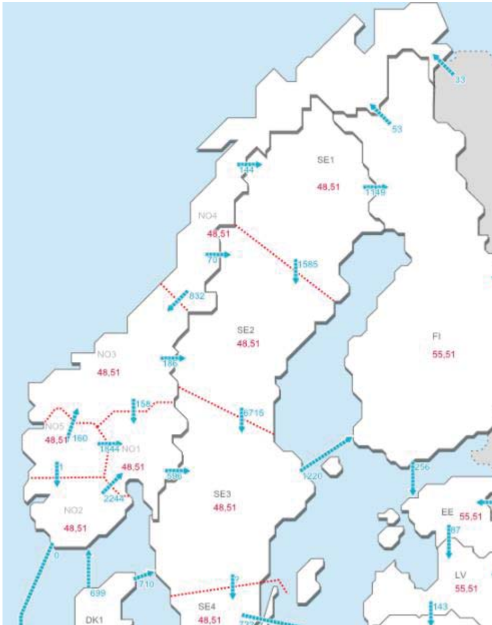
Figur 2.15 viser de forskjellige prisområdene i Norden, med el-spotprisen (€/MWh) for hvert område farget i rødt, og flyt av kraft (MW) mellom de ulike områdene farget i blått. Bildet er hentet fra Statnett: Tall og data fra kraftsystemet.
