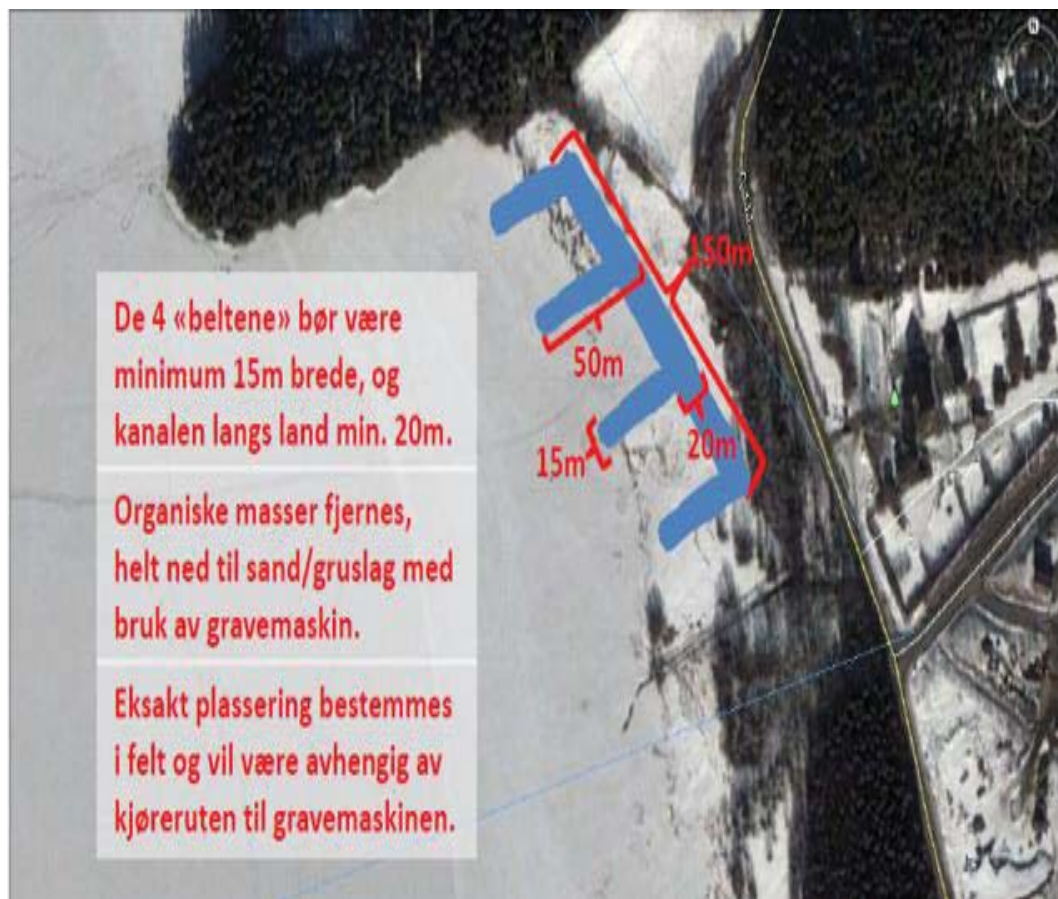
Figur 11. Restaureringstiltak i Hammervatn naturreservat, kanalene er basert på tiltakene skissert i tilstandsrapporten. Naturrestaurering AS (2016).
