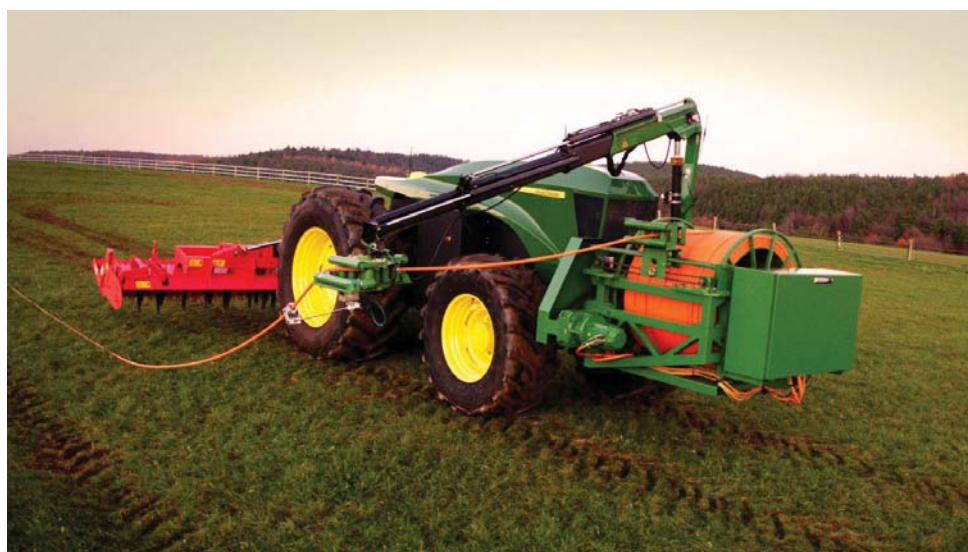
Figur 2 - illustrasjonsbilde av John Deere sin nye elektriske traktor "GridCON" med 1 km kabel tilknyttet strømnettet.
