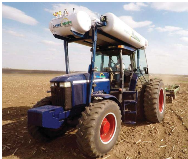
Figur 1 - illustrasjonsbilde av den ombygde John Deere 7810 med hydrogen og ammoniaktank (Schmuecker, 2018).
