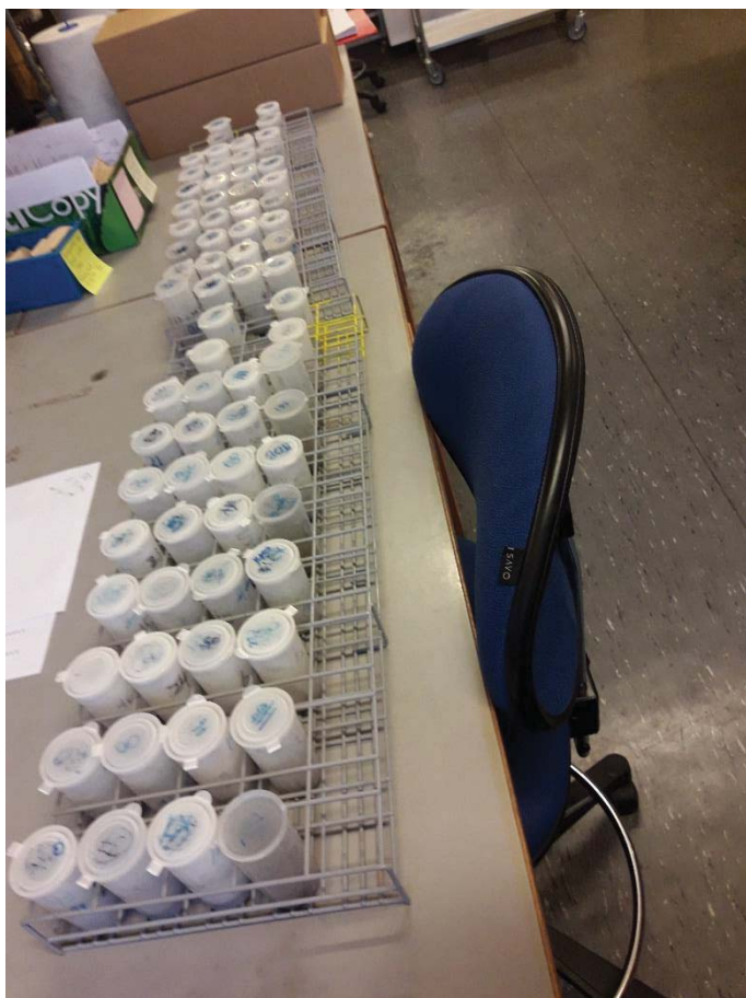
Bilde 23 viser «Ola-beger» (50 ml) med jord i løsning med vann eller \text{CaCl}_2 , klargjort for måling med pH-meter.
