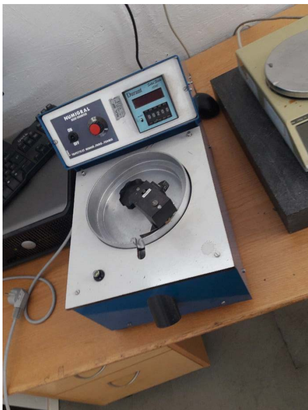
Bilde 19 viser Numigral telleapparat for korn.
