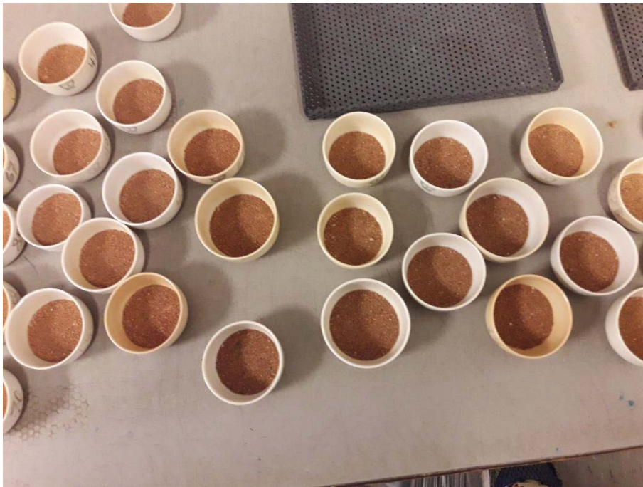
Bilde 21 viser digler med jord etter gløding.
