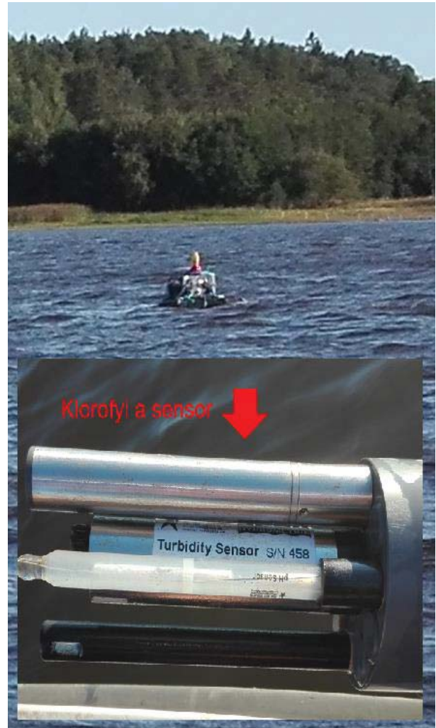
Figur 4: Billede af kassen indeholdende UniLogCom datalogger, bilbatteri og tilkoblet multimarametersensoren MPS-K16 fra SEBA Hydrometries (nederst). Billede taget fra Isesjøen, sommeren 2018
