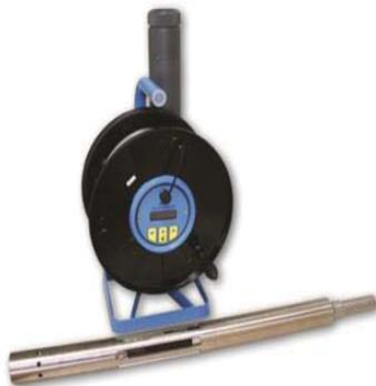
Figur 5: SEBA Hydrometrie KLL-Q-2 med sensor. Transportabelt måleinstrument til feltundersøgelser. Kilde: SEBA Hydrometrie
