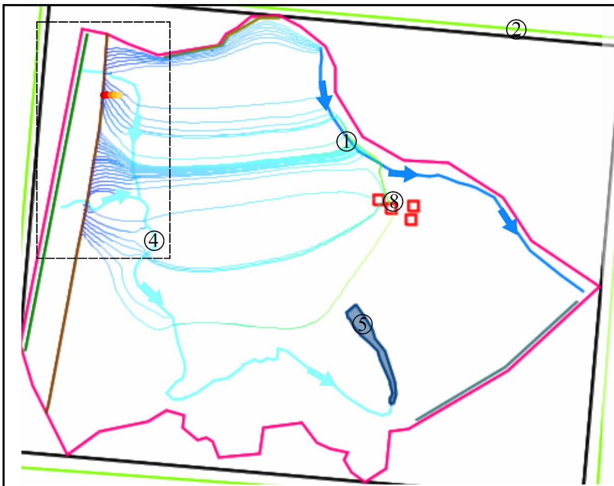
Figur 4-11 Strømningslinjer som en forurensning bruker dersom den hadde blitt sluppet fra den nye riksveg 3. Se tabell 3-8 for grensebetingelser. Stiplet linje viser utsnittet som er brukt i figur 4-11 og mørk rødt, rødt, brunt, gult og lysegult punkt representerer henholdsvis (15,23,1), (16,23,1), (17,23,1), (18,23,1) og (19,23,1) i figur 4-12
