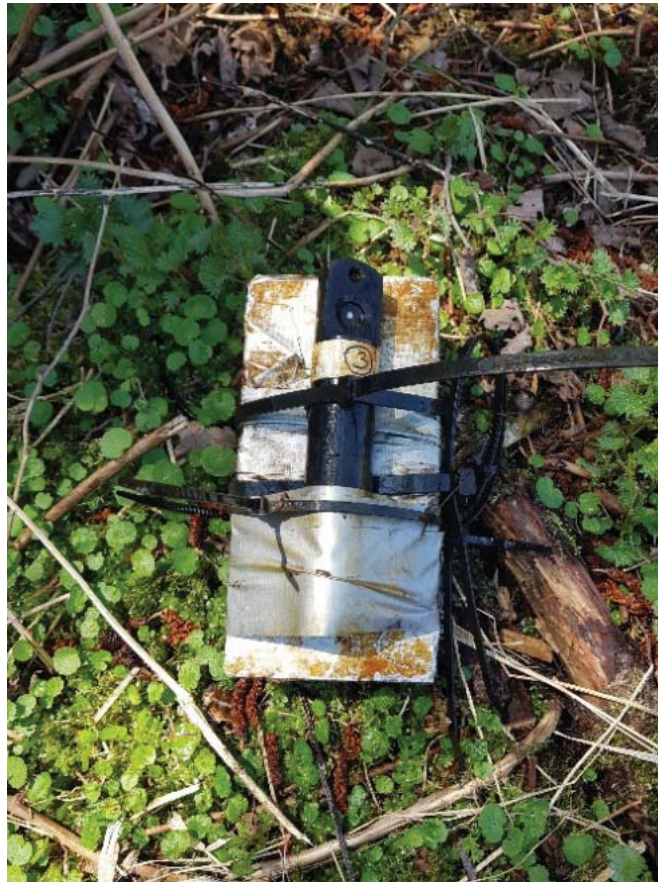
Figur 3.2: Bilde av ferdig sikret logger som måler temperatur og ledningsevne (Foto: Daniel Almhjell).
