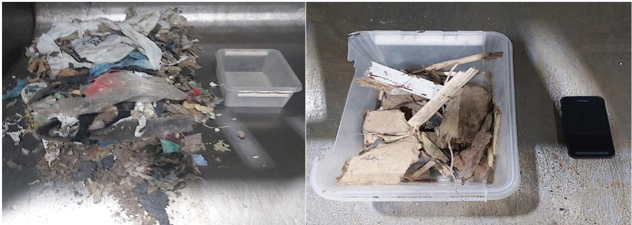
*Figur 10 Bilder fra plukkanalyse hos Norsk Gjenvinning mars 2019. Bildet til venstre viser det representative avfallet spredt utover fast dekke før det er sortert. Bildet til høyre viser en sortert beholder med treavfall med en smarttelefon som representerer størrelsesorden.*
