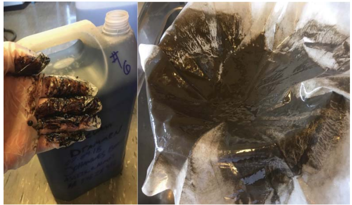
Figur 2.5: filtrering av sigevann med et 40cm foldefilter. Bildene viser sigevann fra Drammen.
