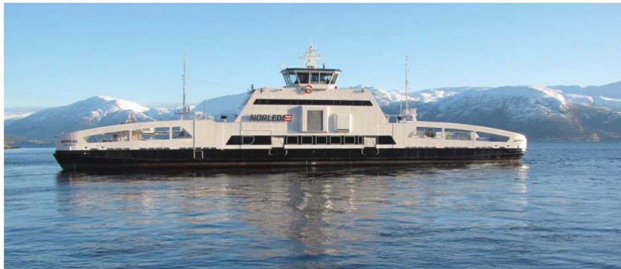
Figur 1: Verdens første fullelektriske passasjerferge, Ampere (Fjellstrand, 2014)
