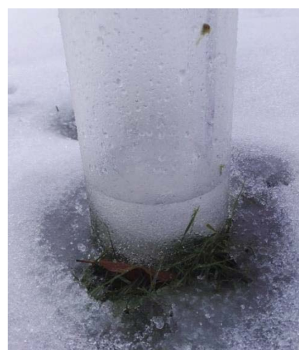
Figur 28 Bilde av islag i bunnen av MPD-sylinder. Bildet er tatt i uke 1, 2018.
