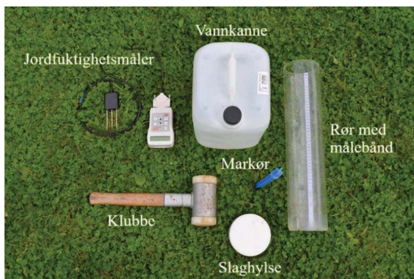
Figur 12 Oversiktsbilde av utstyr brukt ved infiltrasjonsundersøkelser med MPD-metoden. Jordfuktighetsmåler ble brukt til å måle volumetrisk vanninnhold. Klubbe og slaghylse ble brukt til å banke røret med målebånd ned i bakken. Vannkannen ble brukt til å frakte vann (10 liter) og markøren ble brukt til å merke målepunkt. Fotograf: Tone Mella.
