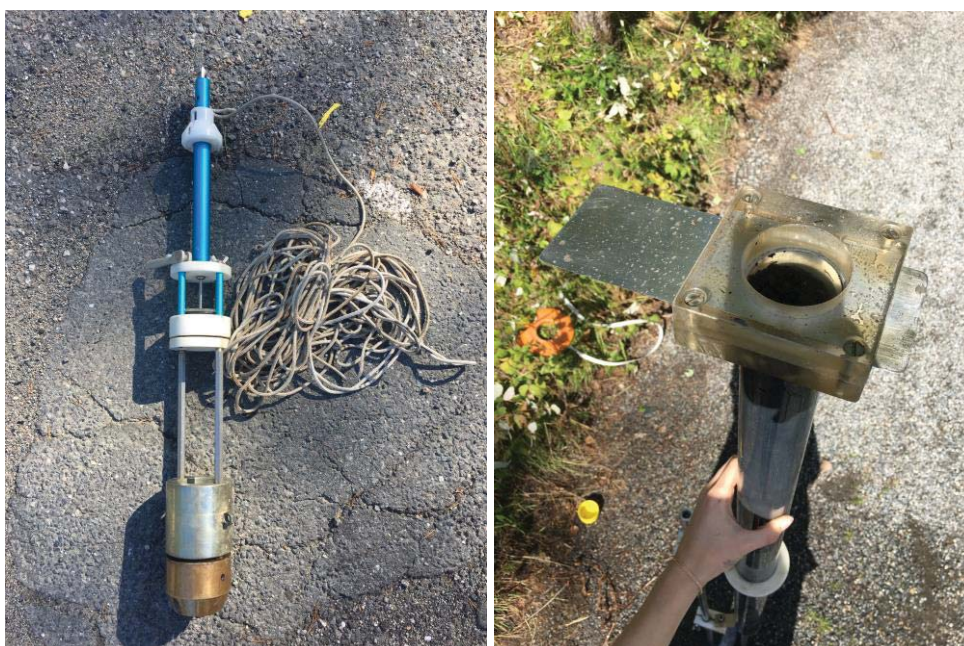
Figur 14. Sedimentprøvetaker Uwitec gravity corer (til venstre) og sedimentkniv lagt oppå stativ (til høyre) (Foto: Lööv, 2017).
