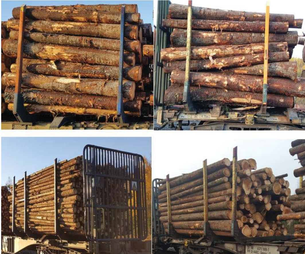
Figur 9. Bilde av vogner med høyt og lavt volum. Bilde øverst til venstre er av et lag med kubbe med høyt volum. Bilde øverst til høyre er av et lag med kubbe med lite volum. Dette laget har lav fastmasseprosent (uryddig) og har litt lav høyde. Bilde nede til venstre er av et lag med fallende lengder med høyt volum. Bilde nede til høyre er av et lag med fallende lengder med lavt volum. Dette laget har ujevn topp som medfører en lav høyde.
