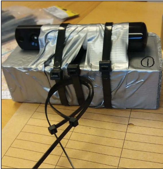
Figur 3.7: Logger med murstein før plassering. Bildet er tatt 07.02.18.
