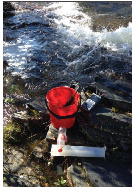
Figur 3.10: Måleutstyr for Saltfortynningsmetoden. Bildet er hentet fra (Kristiansen 2015).
