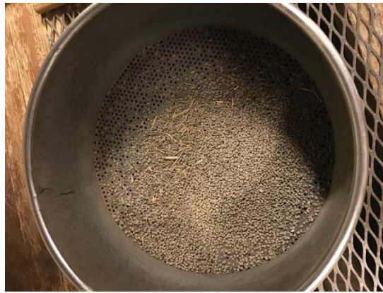
Figur 6: Jorden fra jordprøven < 2 mm i figur 5 som ikke kommer gjennom en sikt med 2 mm sirkulære hull (foto: Stine Hagen)
