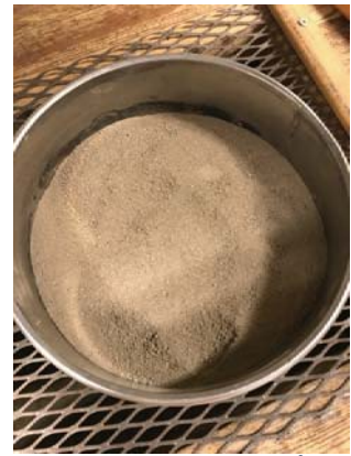
Figur 7: Jordprøven etter å ha blitt siktet gjennom en sikt med sirkulære 2 mm hull (foto: Stine Hagen)
