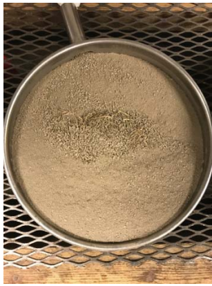
Figur 5: Jordprøve siktet gjennom en sikt med kvadratiske 2mm hull (foto: Stine Hagen)
