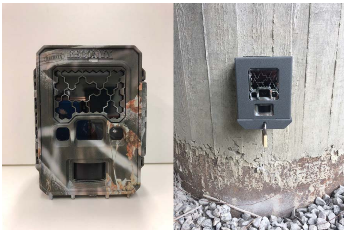
Figur 6. Til venstre et viltkamera av merket Reconyx PC900. Til høyre er samme kamera montert i en tyverisikker boks på lokaliteten Langbakk. Foto: Vanessa Marie Ellingsen.
