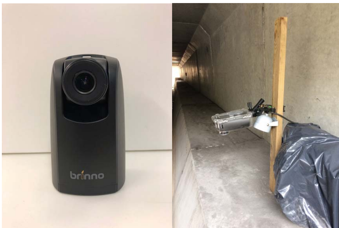
Figur 8. Til venstre et fotokamera av merket Brinno TLC200. Til høyre samme kamera i vanntett beholder og montert sammen med IR-lys (lampen som sitter rett under kameraet) og bilbatteri (i sort søplesekk) på lokaliteten Jonsten. Foto: Vanessa Marie Ellingsen.
