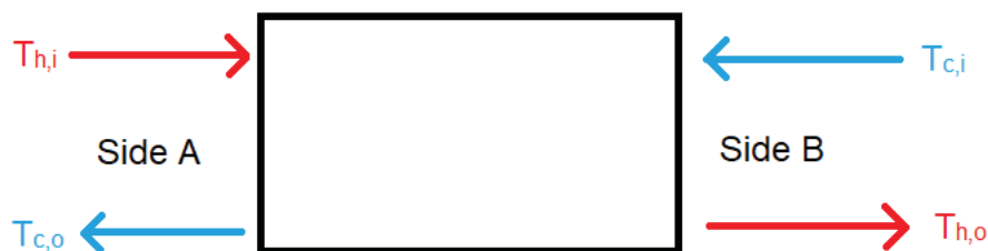
Figur 9: Prinsippskisse av en varmeveksler. De røde pilene er den varme strømmen, hvor T_{h,i} og T_{h,o} er temperaturene henholdsvis inn og ut av veksleren. De blå pilene er den kalde strømmen, hvor T_{c,i} og T_{c,o} er temperaturene inn og ut.
