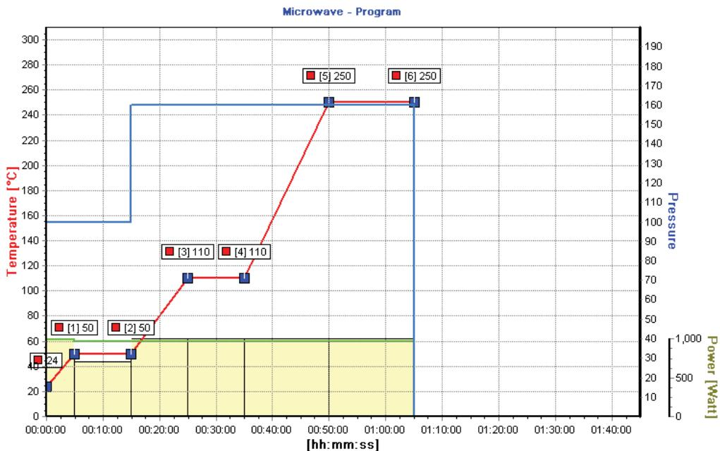
Figur 4: Gjev ei oversikt over trykk-, temperatur- og energiutvikling under prøvedekomponeringa i Milestone UltraClave på programmet "pyseoppslutting" (Jensen 2016b).
