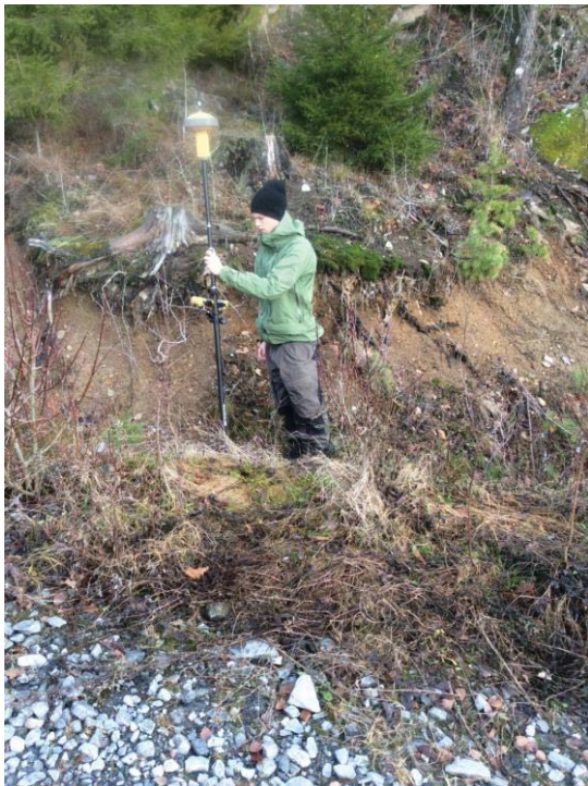
Figur 6: Referansemåling med landmålingsutstyr. Foto: Jan Bjerketvedt
