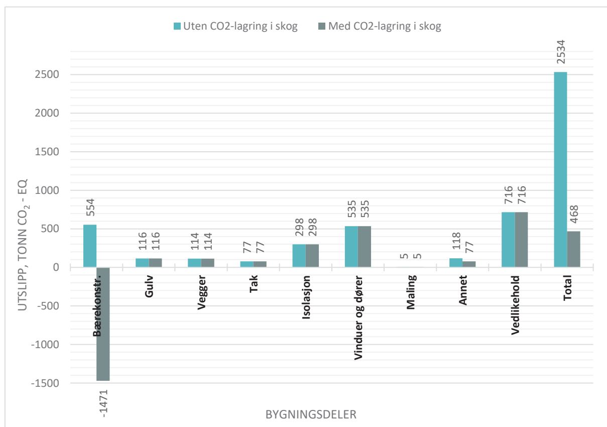
Figur 11: Klimagassutslipp (tonn CO 2 -eq) fordelt på bygningsdeler i alt. A (med og uten hensyn til CO 2 -lagring i skog).
