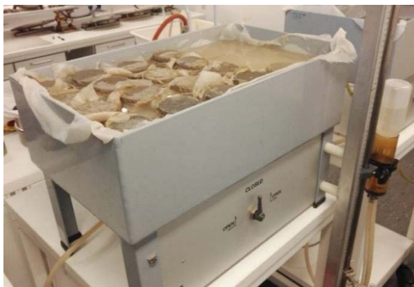
Figur 30: Jordprøver plassert i en sandboks, dekket med nylonduk.
