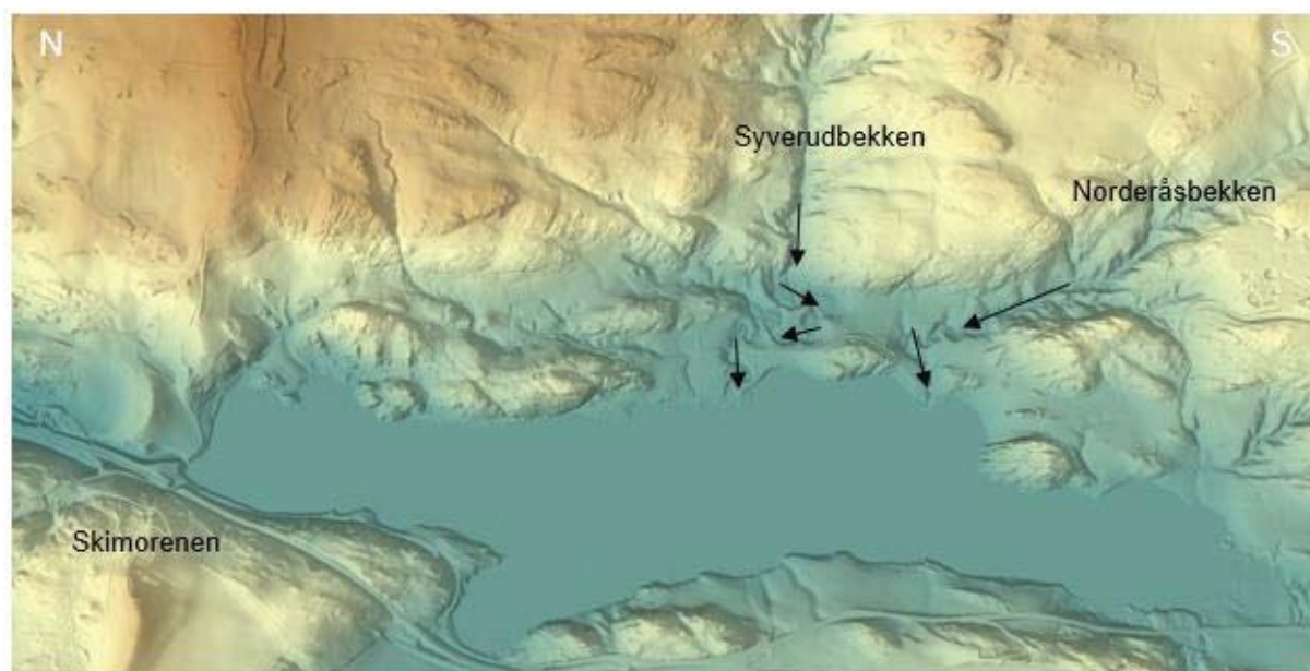
Figur 4.40: Digital høydemodell i 3D med fjellskygge (asimut 270) fra nedbørsfeltet til Årungen. Modellen er fremstilt i ArcMap ved bruk av LiDAR-data fra Høydedata (Høydedata 2016).
