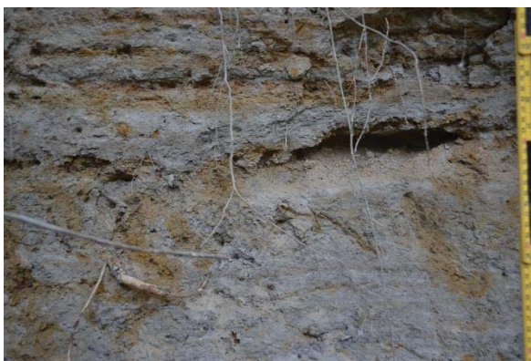
Figur 4.25: Viser laget med grovere lettpakket fraksjon (5 cm), med rødlige linjer som følge av rotsystem.
