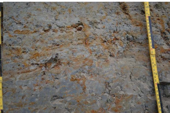
Figur 4.26: Viser diskontinuerlig kompakt lag med sandlag (rødlig).
