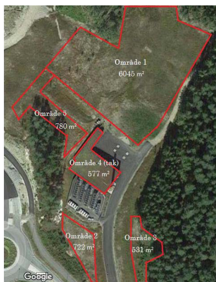
Figur 4.5: Viser oppdelingen og størrelsen av de ulike områdene for etablering av PV system. Område 1 strekker i tillegg litt nordover utenfor bildet. Skjermdumpen er fra google maps.
