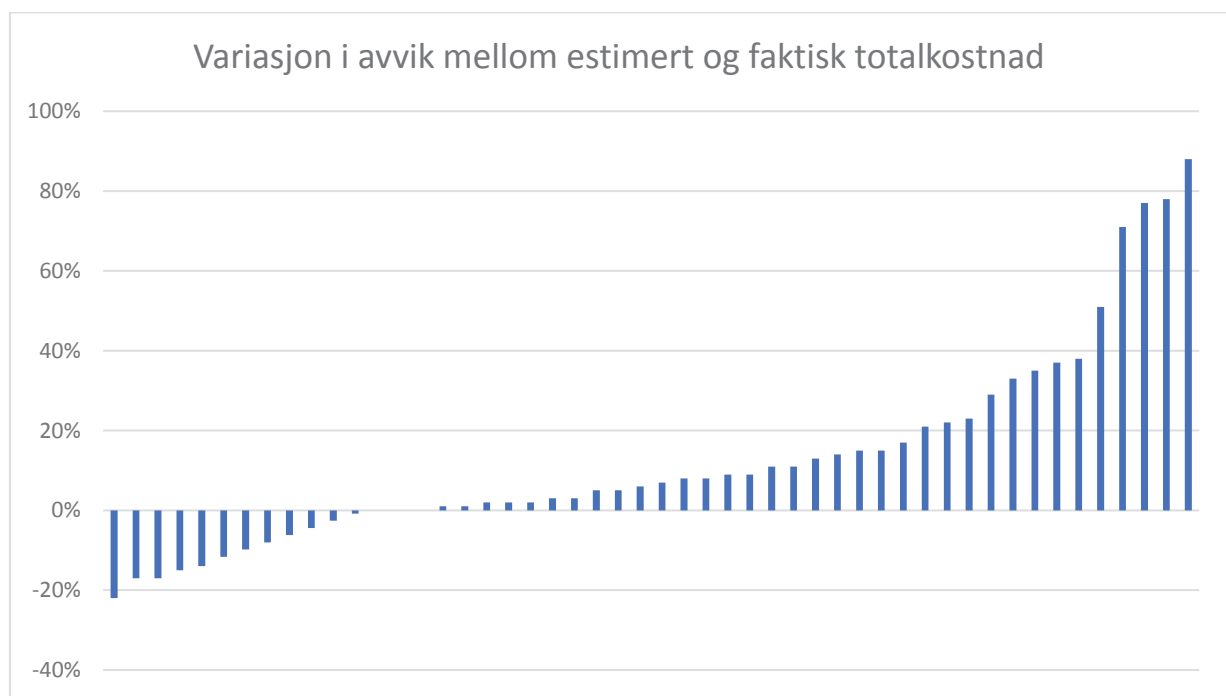
Figur 7: Variasjon i avvik mellom estimert og faktisk totalkostnad, oppgitt i prosent i stigende rekkefølge fra minst til størst
