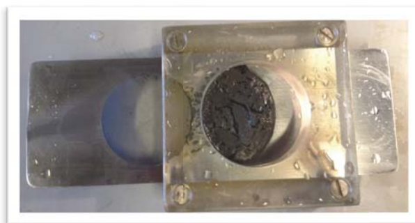
Figur 5: Skjæreredskap til å dele sedimentsøylen.
