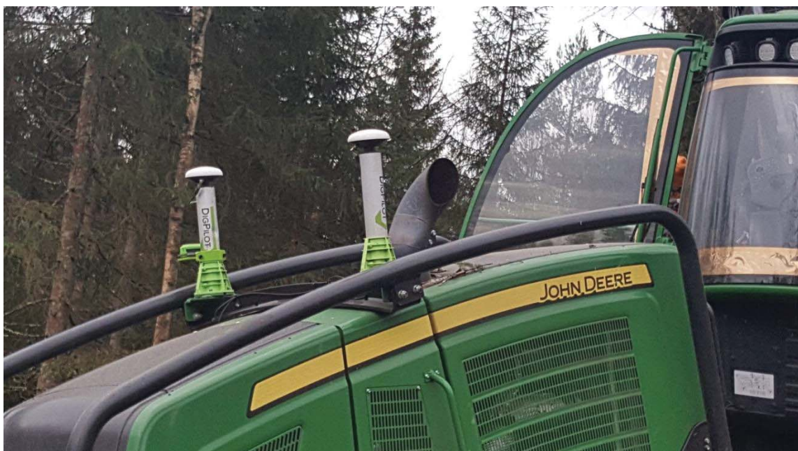
Figur 2: John Deere 1270E med ekstra GNSS antenner
