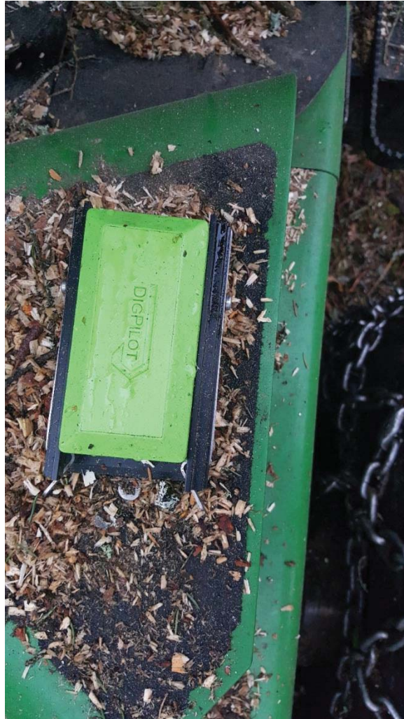
Figur 3: En trådløs vinkelsensor fra DigPilot.
