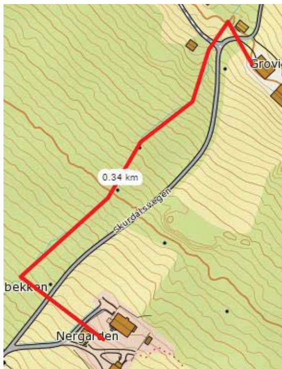
Figur 22: Lengde på strømkabel i trekkerør i alternativ 1.
