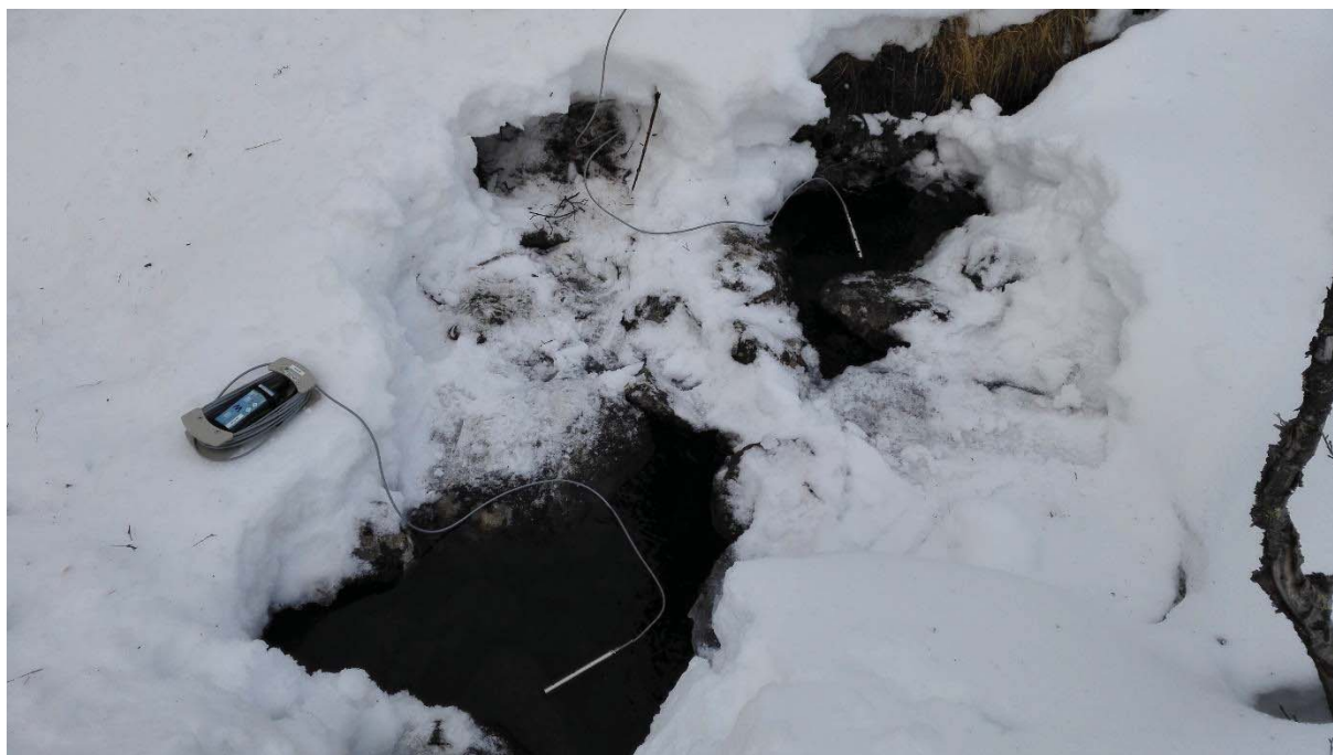
Figur 6: Sensorene er plassert i bekken, og senderne ligger på elvebredden (privat foto).
