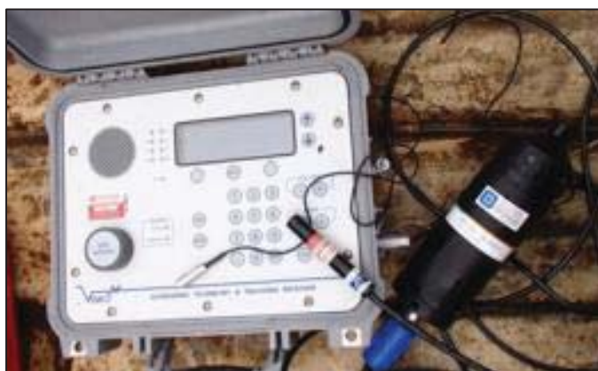
Figur 15. Manuell peiling fra Evangervatnet med bruk av mottagerne VR100 (venstre) og TBR700. (Foto: Henning Andre Urke)
