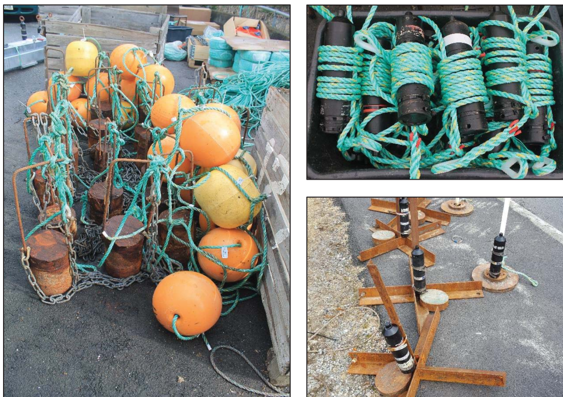
Figur 13. Utstyr til montering av lyttestasjoner. Søkke og blåser til montering i innsjøer (til venstre), lyttebøyer festet til tauverk (øverst til høyre) og lyttebøyer montert på anker.
